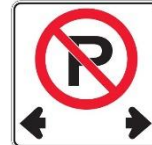
Parkeerverbod aan beide zijden van het bord. Indien de pijl in een bepaalde richting wijst, geldt het verbod uitsluitend voor de aangewezen richting.
