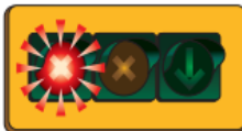
Controlesignaal: Geplaatst boven rijstroken om aan te geven welke open zijn om te rijden. Hier: ROOD = niet rijden op rijstrook.
